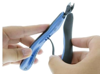
5. Wenn der dem Gelenk am nächsten liegende Positionierungs-Steckplatz verwendet wird, ist die Spannung am geringsten, wohingegen die Feder bei Verwendung der am weitesten vom Gelenk entfernten Position am stärksten gespannt ist.
