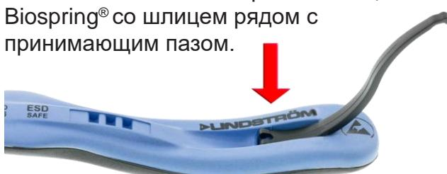
2. Одновременно вставьте широкий конец пружины в принимающий паз (стрелка 1) и поверните узкий скруглённый конец вверх (стрелка 2).
