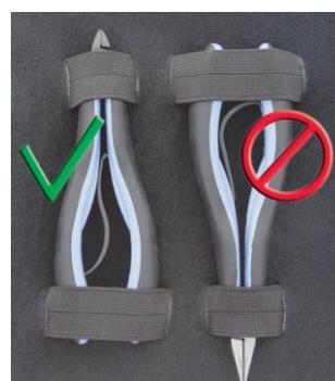
Nouveau Biospring® (1) comparé à un ressort déformé (2) retiré d'une pince stockée en position fermée avec le ressort fixé aux deux extrémités.
