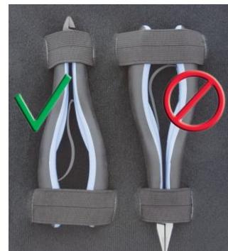
Новая возвратная пружина Biospring® (1) и деформированная пружина (2), снятая с плоскогубцев, которые хранились в принудительно закрытом положении с закреплённой на обеих сторонах пружиной.
