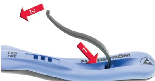
3. Если широкий конец пружины вошёл правильно, вы услышите щелчок. Если щелчка не последовало, пружина установлена не до конца и выпадет из инструмента в процессе использования.
