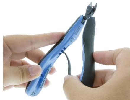
5. Placera fjädern i öppningen närmast leden för en lättare spänning och längst bort för kraftigare spänning.
