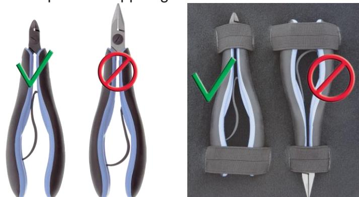
Ny Biospring® (1) jämfört med en deformert fjäder (2) som avlägsnats från en tång med handtagen stängda och fjädern fäst i båda ändar.
