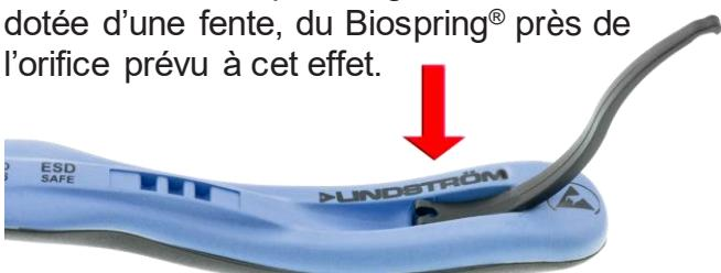
2. Poussez l'extrémité large du ressort dans la fente (flèche 1) tout en faisant tourner l'embout fin vers le haut (flèche 2).
