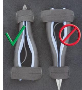
Biospring® nuevo (1) en comparación con un muelle deformado (2) retirado de unos alicates almacenados forzando el cierre de las asas y con el muelle insertado en ambos extremos.
